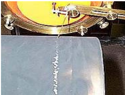
Figure 2 : Membrane, aiguille, tambour et trace d'un signal du Phonautographe de Scott (collection particulière).
